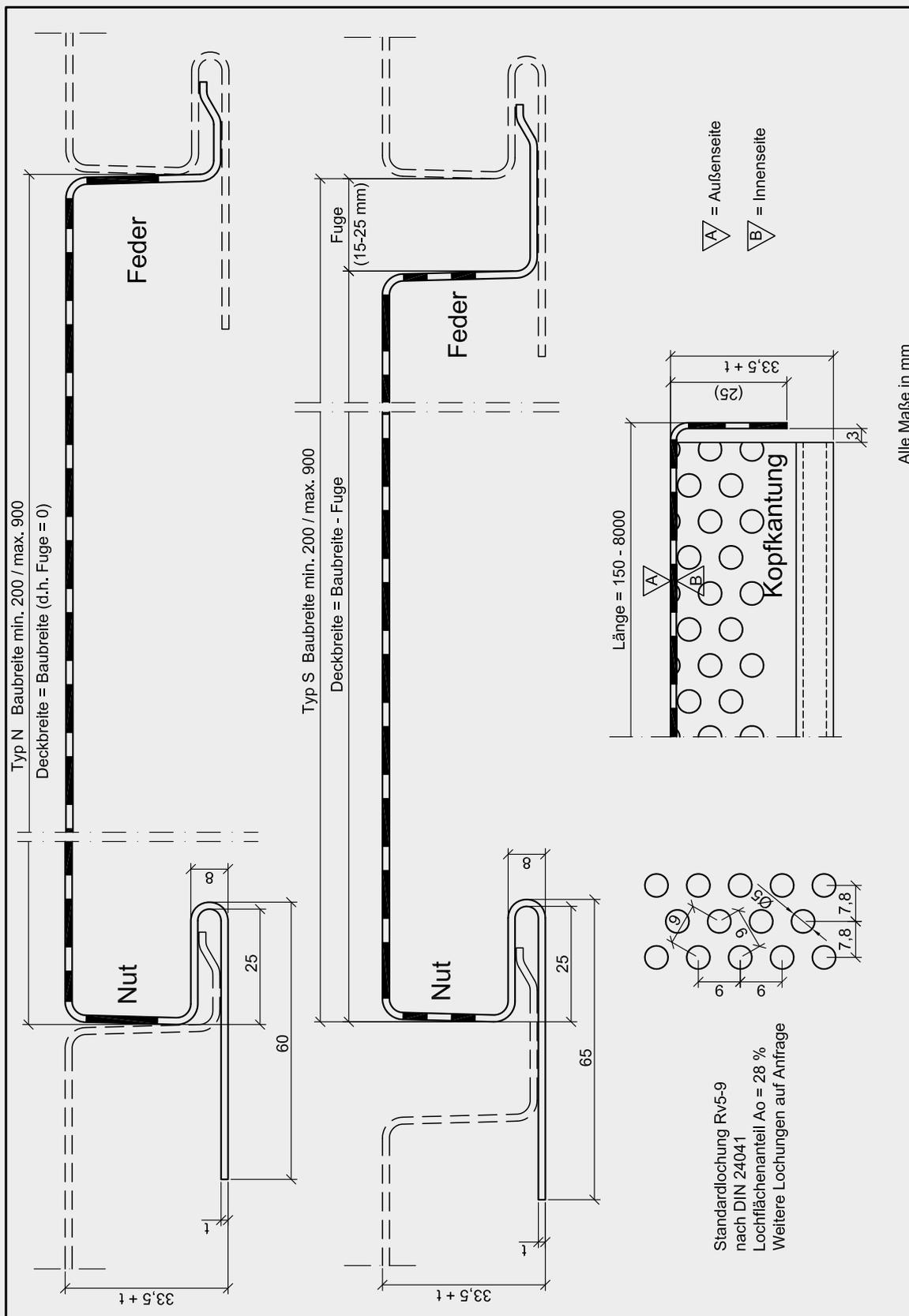
**Panelquerschnitt gelocht:** Lochbild: Rv 5-9 A<sub>0</sub> 28 %
