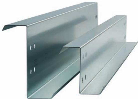
WP Z-Profile dienen als Unterkonstruktion für die Dacheindeckung. Die Montage erfolgt als Einfeldträger oder wahlweise als Koppelträger.
