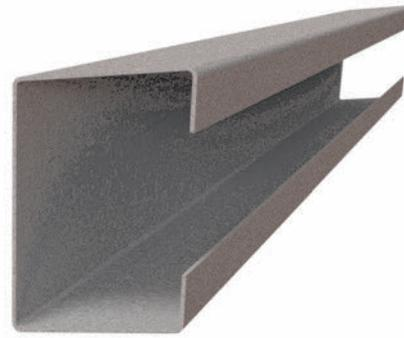
WP Traufriegel finden ihren Einsatz im Dachrandbereich. Sie fungieren gleichzeitig als Z-Pfetten bzw. Wandriegel und ermöglichen somit die Aufnahme von Lasten aus der Dach- sowie der Wandkonstruktion. Die Montage erfolgt grundsätzlich als Einfeldträger.
