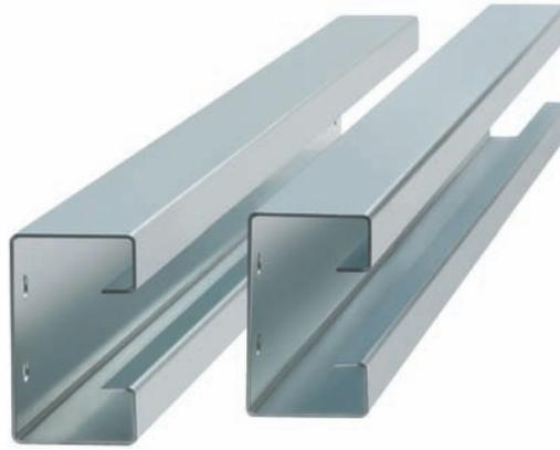
WP CL-Wandriegel dienen ebenfalls zur Aufnahme der Wandelemente und werden horizontal sowie vertikal als Einfeldträger vor oder zwischen den Stahlbindern montiert. Durch eine zusätzliche Ankantung, den sogenannten Bördel, weisen CL-Profile eine höhere Tragfähigkeit gegenüber C-Profilen auf.
